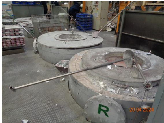
รูปที่ 29 การอุ่นอุปกรณ์และเศษอลูมิเนียม
